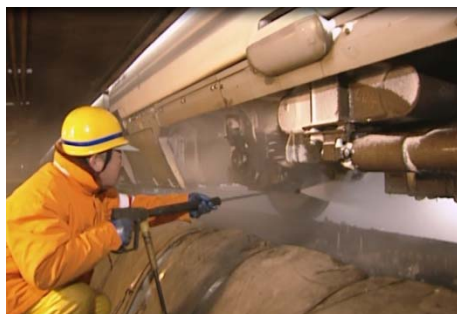
図7 高温高圧洗浄機を使用した雪落とし作業
