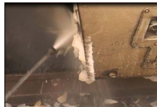
図7 高温高圧洗浄機を使用した雪落とし作業
