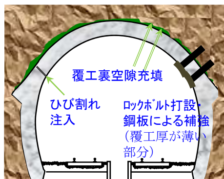
大規模改修工事 (トンネル：変状発生抑止対策)
