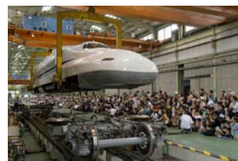
「車体上げ・載せ作業実演」
