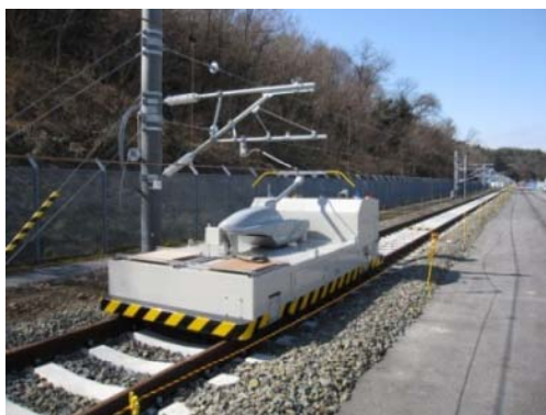
電車線試験装置
