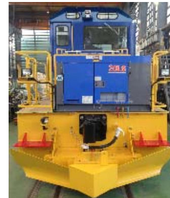
スノープラウ(既存付替)
