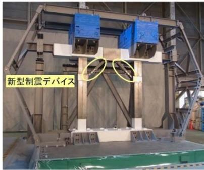
新型制震デバイスによる高架橋変位抑制対策 (地震対策)
