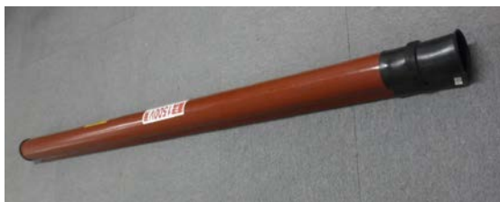
落下したものと同一絶縁カバー
