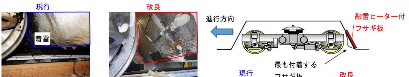
※台車カバー形状の改良、融雪ヒーター取付けともに特許出願中
