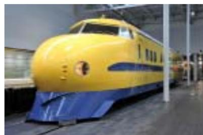
922形新幹線電気軌道総合試験車
