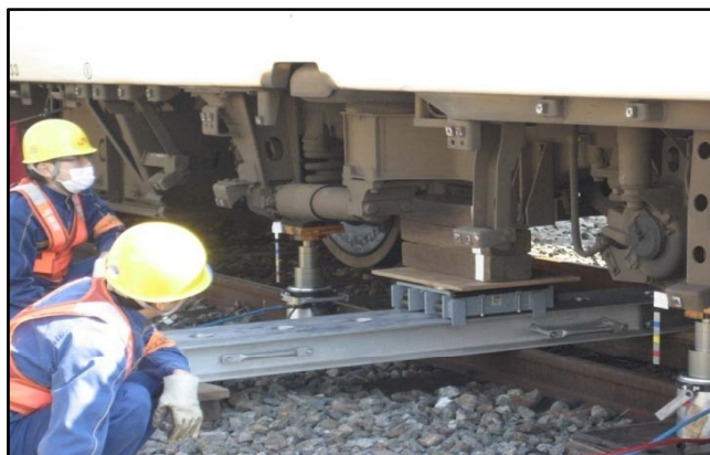
写真1 N700系脱線復旧訓練
