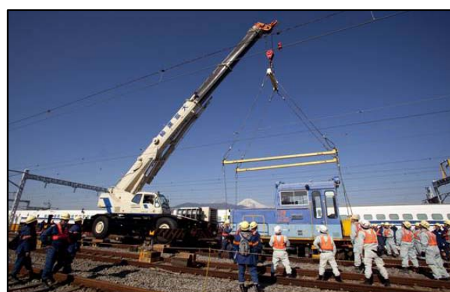
写真5 大型クレーン車を使用した 保守用車脱線復旧訓練
