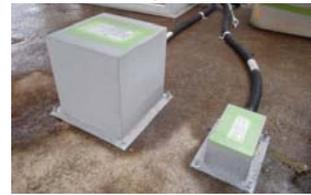
②計測センサーにより橋脚の固有振動数を計測
