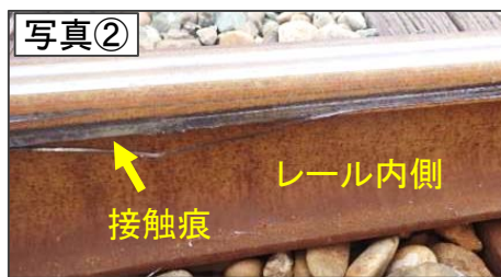
レール内側の接触痕
