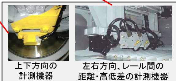
軌道 状態監視 システム
