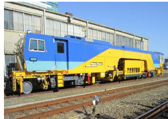
線路設備の復旧に用いる保守用車 (マルチプルタイタンパ)
