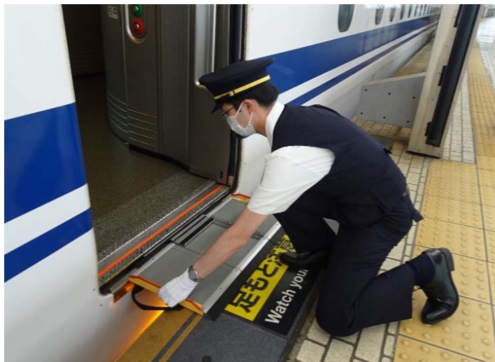
係員による渡り板の設置
