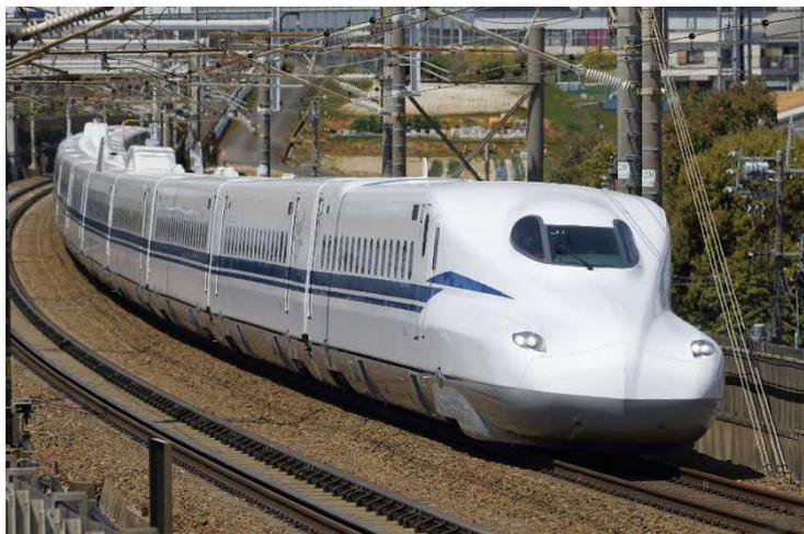
N700Sは、これまで積み上げてきた技術開発の成果を取り入れ、安全性・安定性の向上、異常時対応力の強化、快適性・利便性の向上、様々な編成長を容易に構成できる「標準車両」等の特長を有しています。環境性能においても、SiC素子駆動システムの採用、車両の軽量化、走行抵抗の低減等により、電力消費量をN700Aタイプからさらに6%削減しています。
