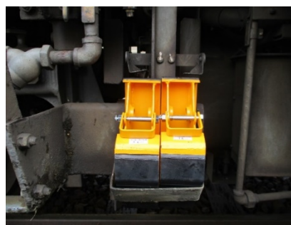
鉄製手歯止め搭載状態 (正常状態)
