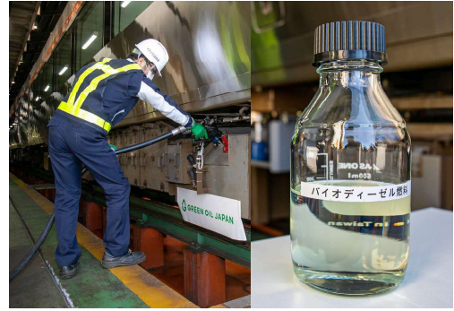
HC85系試験走行車における バイオディーゼル燃料の試験
