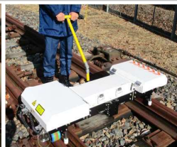
検査装置の導入による省力化 (開発中の分岐器検査装置)
