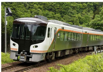
ハイブリッド方式を採用した 新型特急車両HC85系
