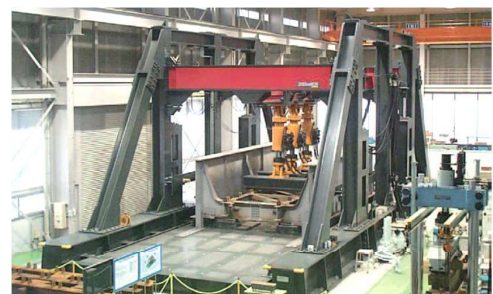
多軸式列車荷重模擬載荷試験装置
