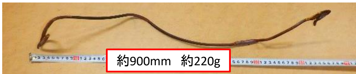
線路上で発見したドロツパの一部
