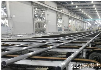
新幹線再生アルミの合金ビレットを、用途に応じて成形する。
