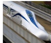
超電導リニア（L0系改良型試験車）
