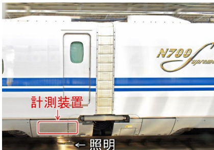
軌道材料モニタリングシステム設置位置
