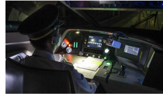
東海道新幹線の自動運転走行試験
