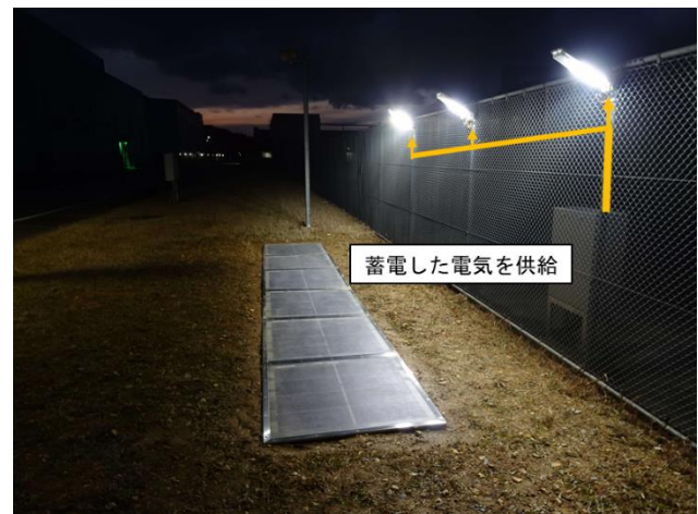
自立給電システムの実証試験の様子
