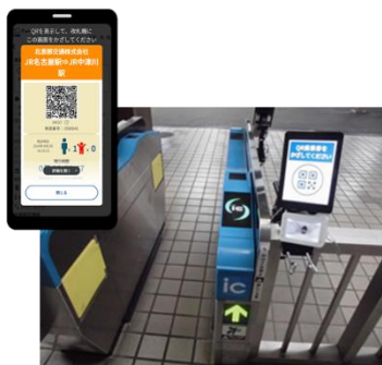
QRコード乗車券を改札機の 読取用カメラにかざして入出場
