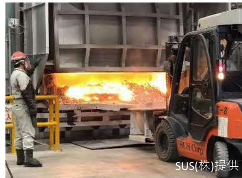
次に、不純物を除いたスクラップ材料を溶解・精製し、純度の高いアルミ合金のみを抽出する。
