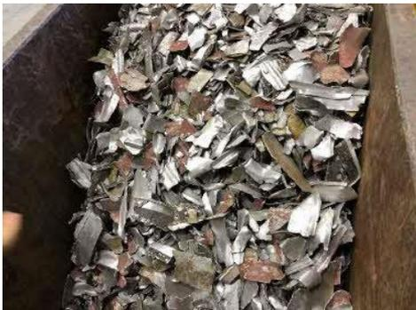
まず、アルミに付着した塗装などを取り除き、不純物が含まれていないスクラップ材料に加工する。
