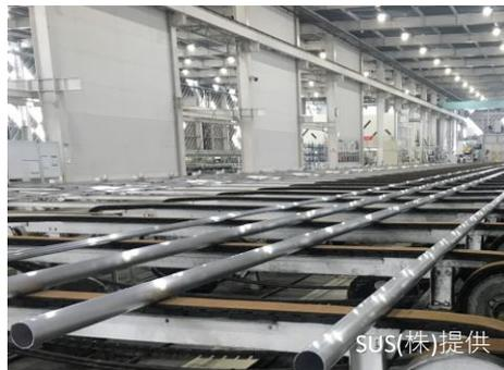
新幹線再生アルミの合金ビレットを、用途に応じて成形する。
