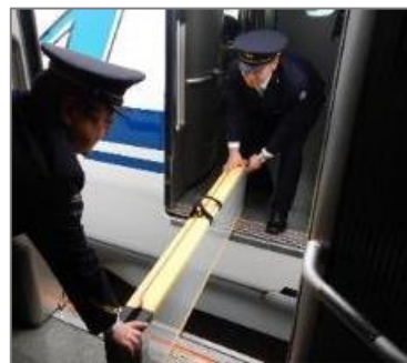
列車間に渡り板を設置
