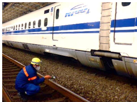
車両下の 脱線防止ガードを点検
