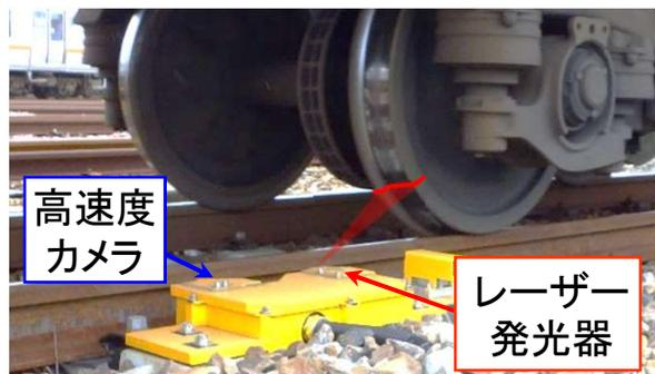
レーザー光を車輪に照射
