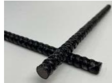
バサルトFRP筋 ※凹凸のある形状とすることで コンクリートとの付着力を向上
