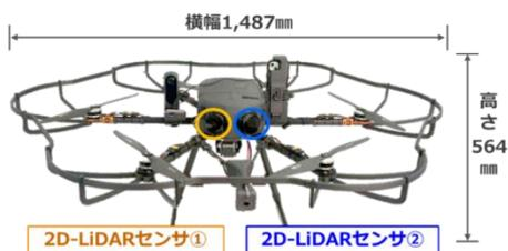
開発した制御方法を搭載したプロトタイプ機
