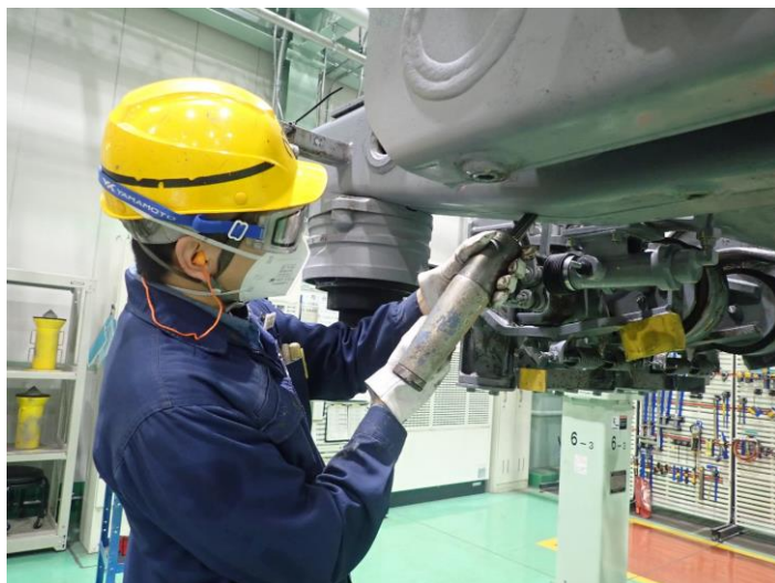
〔従来〕 振動による塗膜除去
